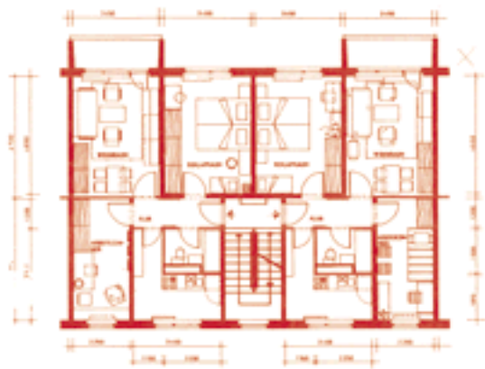
Typische Grundrisse in Plattenbauten
